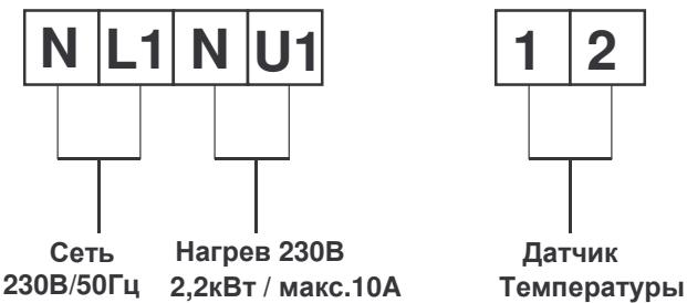
Кабель датчика температуры можно удлинить экранированным проводом ( $2x0,75\text{мм}^2$ ) до 10 м. Экран присоединить к клемме 1. Непременно прокладывать проводку водоустойчиво. Избегать прокладку кабеля датчика в близи с силовыми кабелями из-за возможных наводящихся помех.
