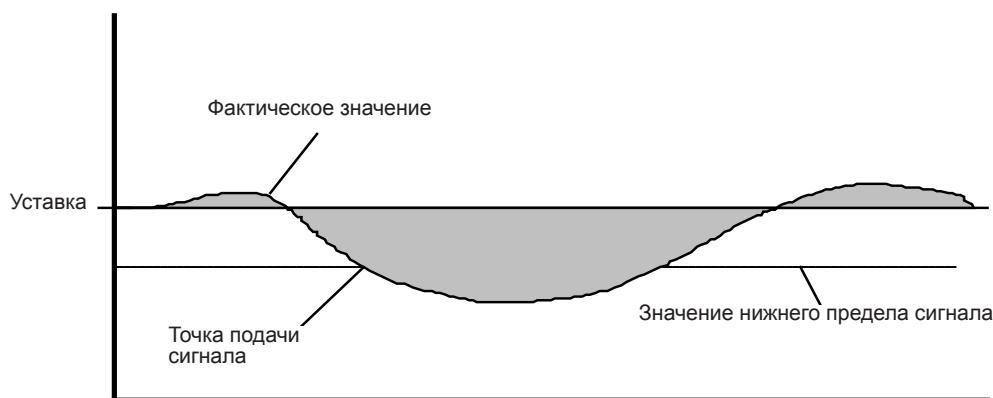
Чтобы задать нижний предел сигнализации нажмите и удерживайте кнопку **Нижний предел Cl/pH [14]**. На дисплеях высвечиваются значения нижних пределов сигнализации для свободного хлора, связанного хлора и pH.
