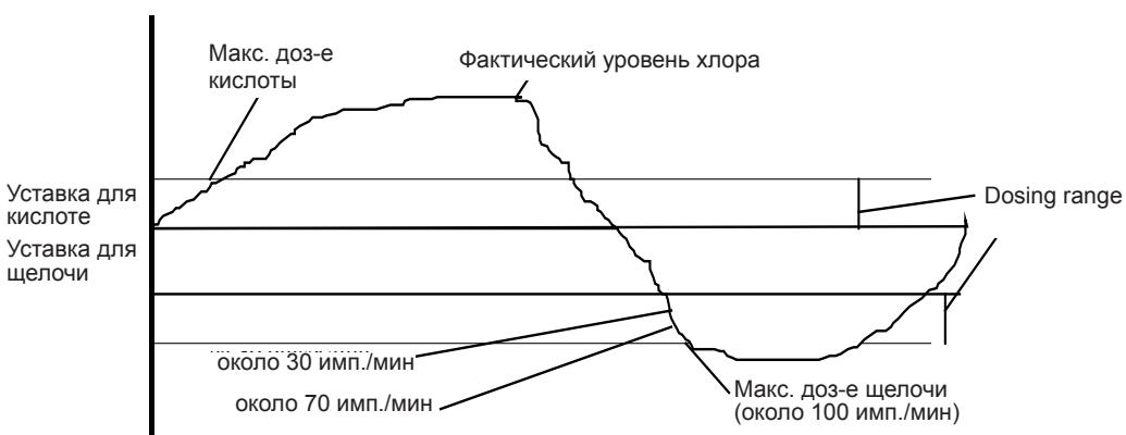
Интервал дозирования (диапазон P\*) означает диапазон, в течение которого дозирование плавно изменяется от 0 до максимального значения. В приведенном выше примере происходит дозирование кислоты, когда фактическое значение (равное значению pH) превышает соответствующую уставку. Дозирование кислоты и щелочи происходит, когда фактическое значение меньше, чем уставка для щелочи. При максимальном дозировании дозирующие насосы обеспечивают максимальную частоту \* движения рабочего органа в минуту.
