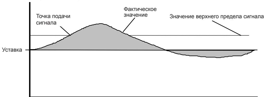
Чтобы задать верхний предел сигнализации нажмите и удерживайте кнопку **Верхний предел Cl/pH [12]**. На дисплеях высвечиваются значения верхних пределов сигнализации для свободного хлора, связанного хлора и pH.
