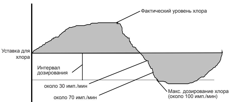
Интервал дозирования (диапазон P) означает диапазон, в течение которого дозирование плавно изменяется от 0 импульсов/мин до максимального числа импульсов в минуту. Корректировка величины интервала дозирования осуществляется в режиме настроек (см. соответствующую главу). Если фактическое значение концентрации хлора (на рисунке) больше, чем значение уставки, дозирования хлора не происходит (0 импульсов/мин).
