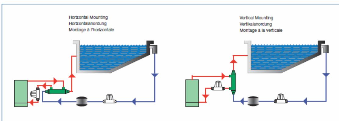
Химические вещества могут повредить теплообменник. Систему дозирования следует устанавливать в нисходящем направлении с невозвратным клапаном. При использовании химических веществ необходимо следить, чтобы в теплообменник не поступали газы во время простоя системы фильтрации.
