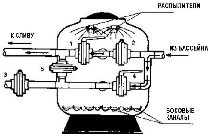
Слой песка внутри фильтра содержит тысячи каналов, по которым просачивается вода. При этом содержащаяся в воде грязь захватывается песком. Когда каналы в песке заполняются грязью, нужно выполнить промывку фильтра обратным потоком воды для поддержания фильтра в оптимальном рабочем состоянии и вымывания накопившейся в нем грязи.
