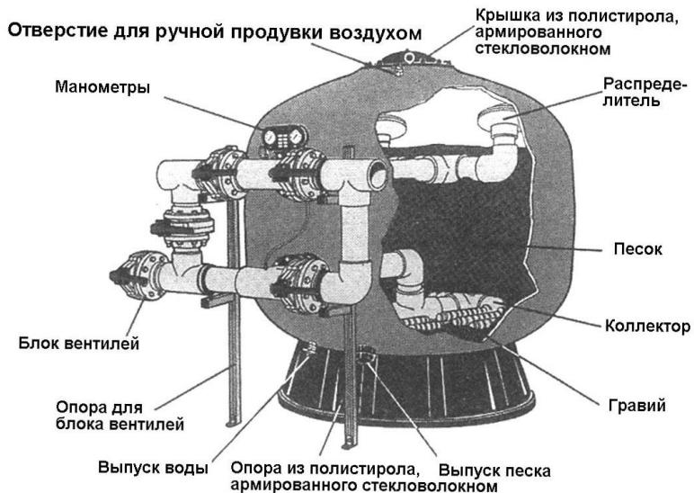
Несомненно, фильтры являются важнейшей составной частью оборудования, используемого для обработки воды в бассейнах. При циркуляции воды фильтры задерживает взвешенные в ней твердые частицы и тем самым очищает воду.
